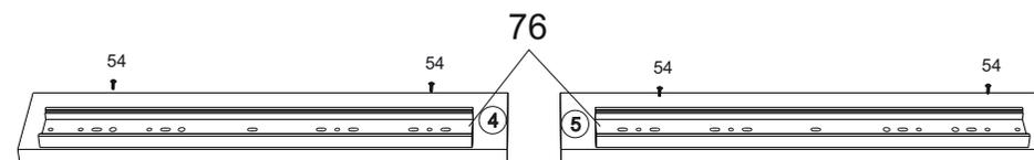
Разъедините направляющие 78 нажав на язычок сбоку направляющей и разъедините. Широкую часть закрепите на боках 3, 4, шурупами 54.
